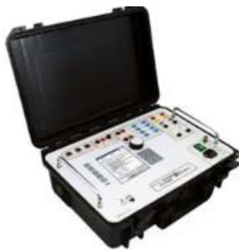
Fig. 7.5.1 – esempio di cassetta prova relè di protezione
