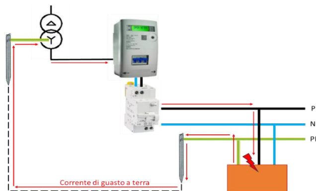
Fig. 7.6.1 – percorso della corrente di guasto a terra in un sistema TT
