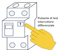
Fig. 7.3.1 – prova differenziali con pulsante di test
